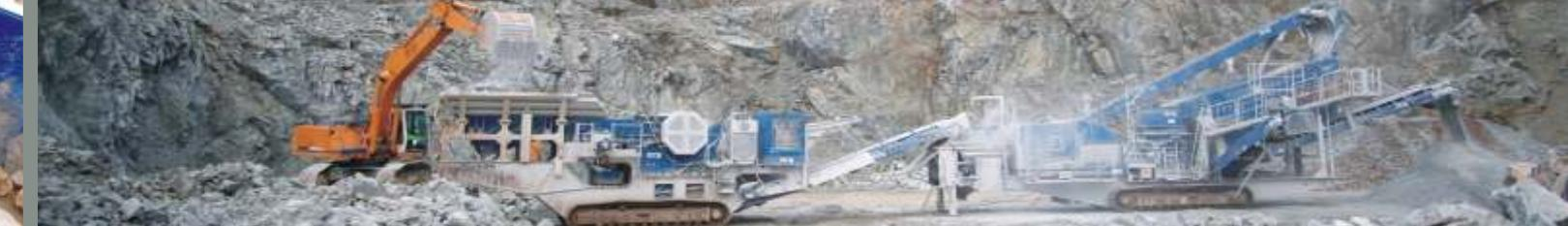
Kleemann jednostruke koljenaste čeljusne drobilice uglavnom se koriste za prethodno usitnjavanje prirodnog kamenja i mineralnog građevnog otpada. Ovisno od polaznog materijala one su prikladne i za proizvodnju
