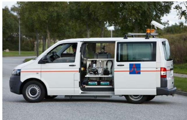
**ASFT Industries AB** je švedska kompanija sa sjedištem u **Kopingebru**, specijalizirana za proizvodnju sustava za kontinuirano mjerjenje hvatljivosti kolničkih površina i sustava za monitoring vremenskih uvjeta na aerodromima.
